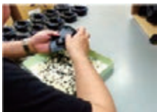
自動車の電動ミラー内部の部品を組立加工しています。
